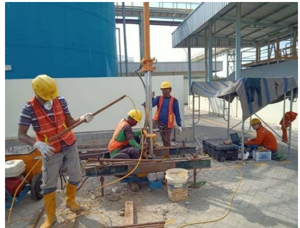
Gambar 7. Tipekal Alat Penekan Konus Dengan Sistem Hidraulik dan Dokumentasi Pengujian CPTu Dilapangan
