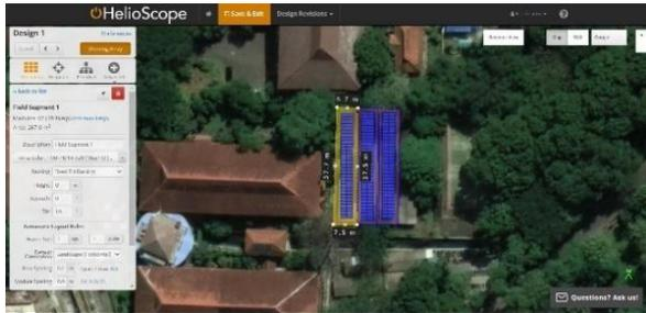
Gambar 2. Potensi Jumlah Modul PV Berdasarkan proses scaling jarak menggunakan Software
