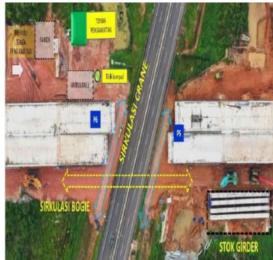
Gambar 2 Ilustrasi Denah Rencana Stok Girder Jembatan Flyover
