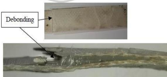
Gambar 6 Terjadi debonding pada variasi 4 serat gelas spesimen 2
