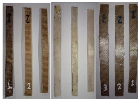
Gambar 18. Spesimen hasil uji bending
